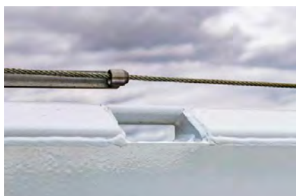
Sécurisation très flexible avec les œillets dans les ridelles (force 2 t).
