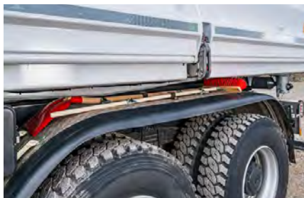
Le bord caoutchouc protège le garde boue lors du rabat-tage de la ridelle latérale à presque 180°.
