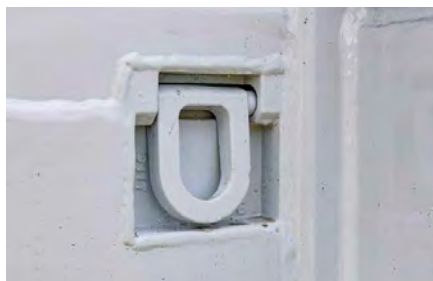
Œillets rabattables dans face avant retiennent la marchandise vers l'arrière (force 1 t).
