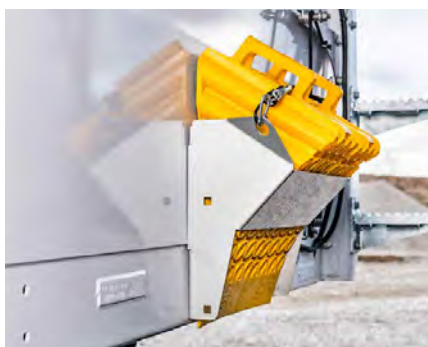
Cales de roue là où l'on en a besoin régulièrement
