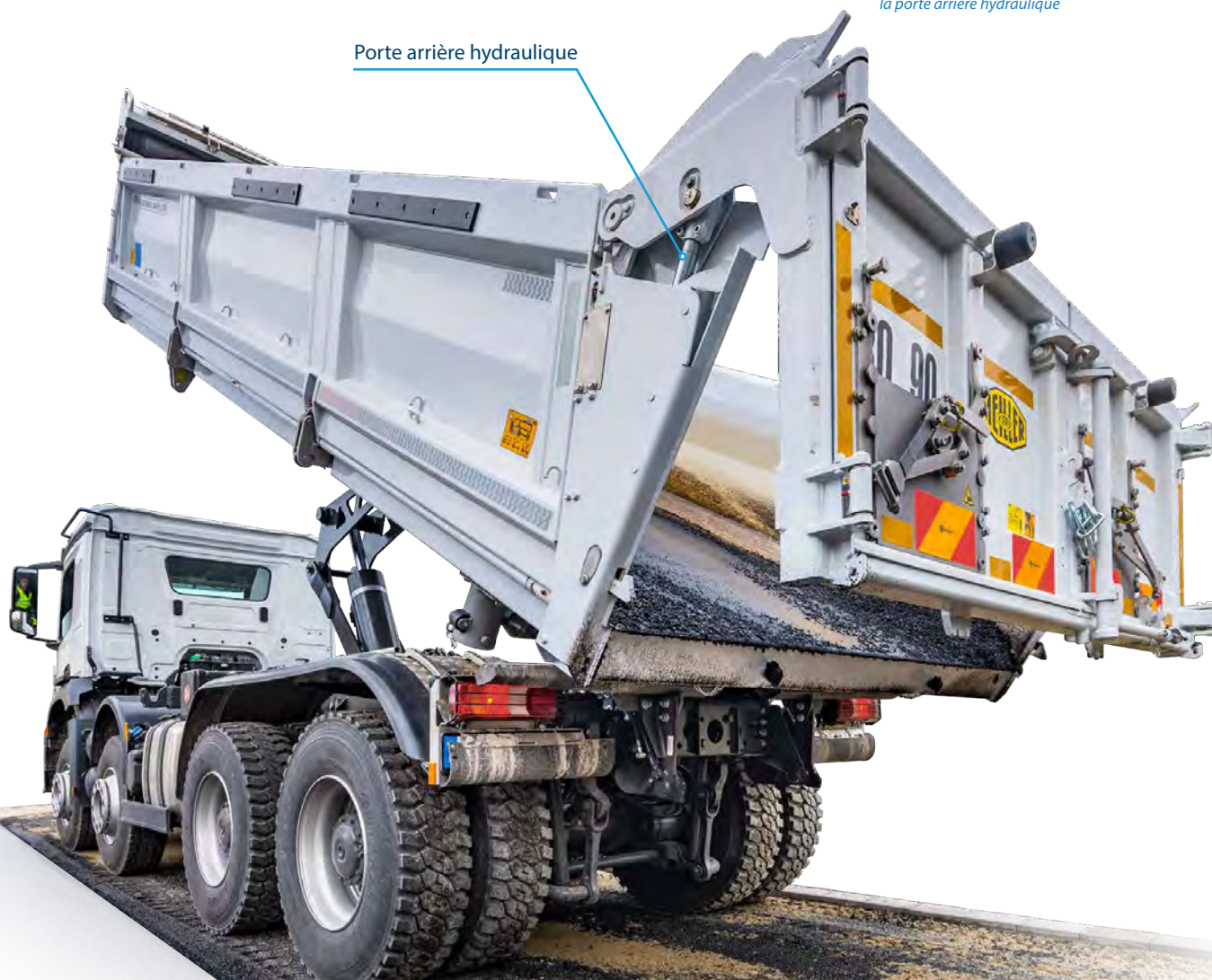
Grande hauteur de passage lors du bennage arrière avec la porte arrière hydraulique
