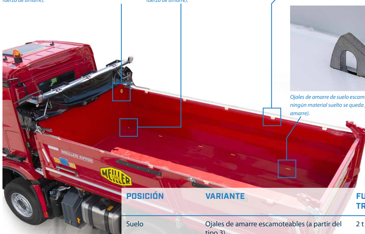
Los ojales de amarre giratorios en la pared frontal mantienen el material de transporte sujeto hacia atrás (1 t de fuerza de amarre).
