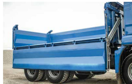
Pared lateral con suspensión pendular y abatible con aligeramiento de muelle.
