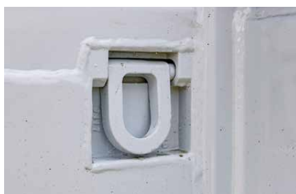
Los ojales de amarre giratorios en la pared frontal mantienen el material de transporte sujeto hacia atrás (1 t de fuerza de amarre).
