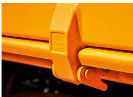
Ganchos para lona integrados en el suelo de la caja basculante
