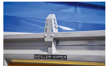
Desviador para el acoplamiento de cabeza esférica
