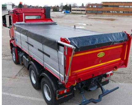
La lona desenrollable lateral de MEILLER se puede manejar desde abajo con una manivela.
