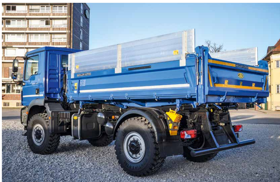
Volquete trilateral de MEILLER con unidad de confort y paredes sobrepuestas de aluminio.
