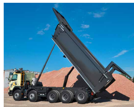
La posición de trampilla posterior elevada permite un gran paso, por ejemplo, para escombros pesados.
