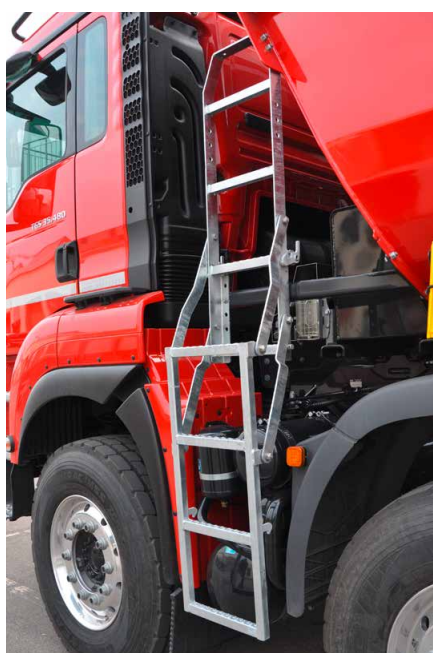
Se abre rápidamente: subida lateral con escalerilla.
