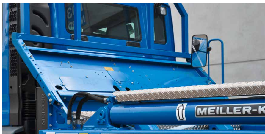
Protección del conductor y de la cabina del conductor: frontal MEILLER en diferentes modelos
