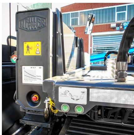
Unidad de mando MEILLER con indicador de control de sobrecarga integrado (serie con equipo telescópico)
