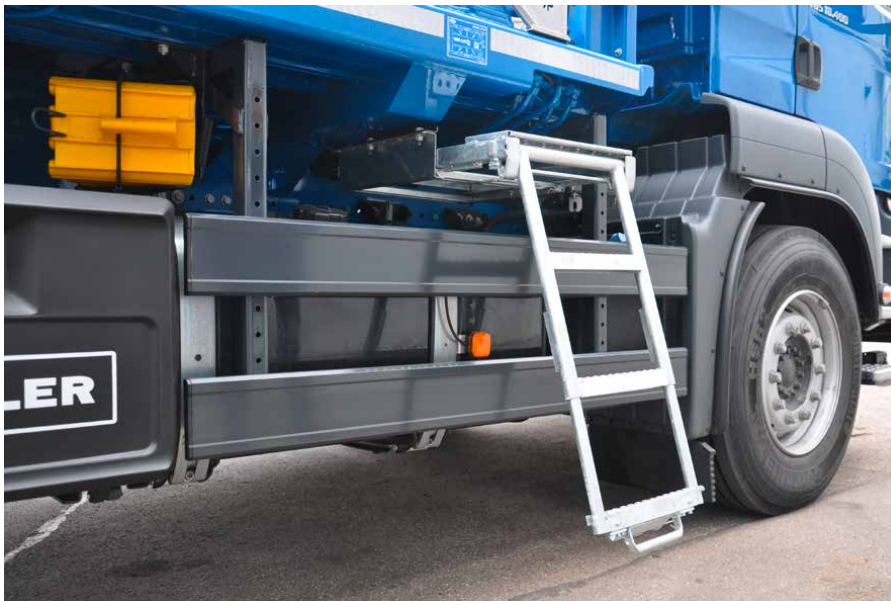
Espacio aprovechado óptimamente: caja de red extraíble entre los ejes.
