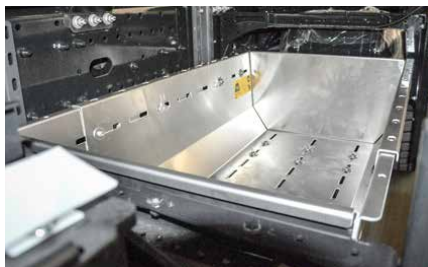
Espacio aprovechado óptimamente: caja de red entre los ejes.
