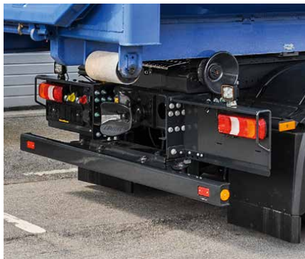
El dispositivo antiempotramiento, siempre en el lugar correcto: plegado al volcar y rodar, desplegado al circular.
