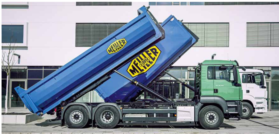
Difícil de alcanzar: gracias a la unidad de eficiencia, la nueva caja basculante sobre rodillos baja el doble de rápido que su predecesora.
