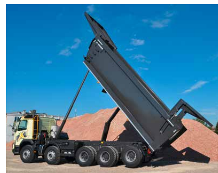
Podwyższone łożyskowanie ściany tylnej zapewnia duży przelot, np. do ciężkich wyburzeń.
