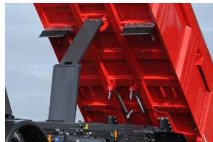
Kleszczowy stabilizator przechylenia MEILLER zapewnia bezpieczeństwo podczas procesu przechylenia.
