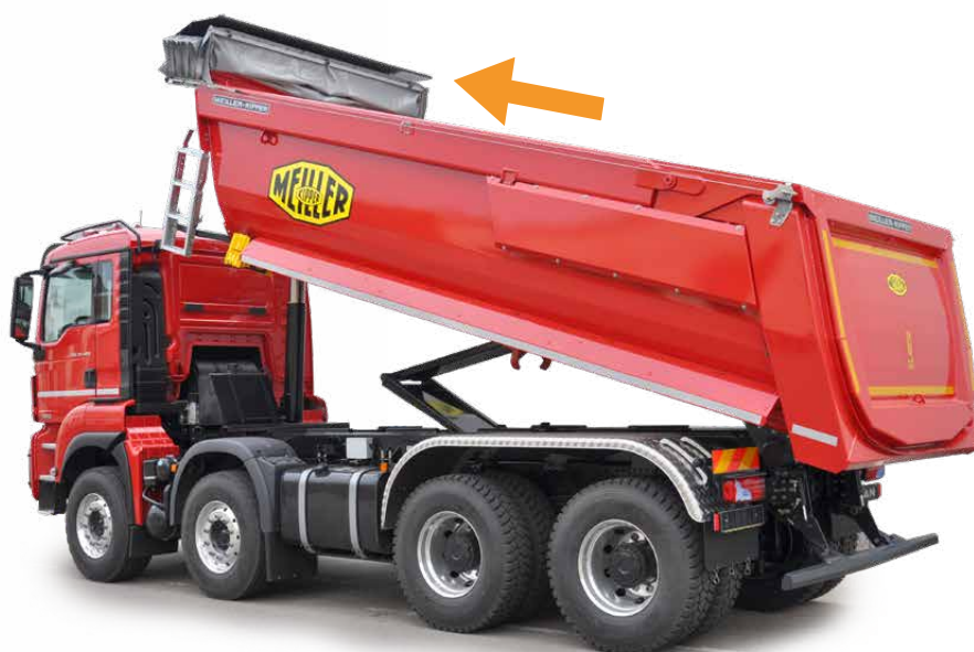
... lub plandeka przesuwna, łatwa w obsłudze przy użyciu zdalnego sterowania.
