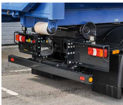
Zabezpieczenie przed wjechaniem zawsze we właściwym miejscu: podczas pochylania i staczania wsunięte, podczas jazdy wysunięte.
