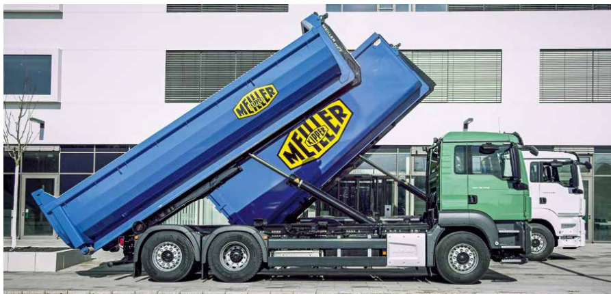
Prawie niedoścignione: nowe urządzenie hakowe w połączeniu z Pakietem wydajności opuszcza się dwukrotnie szybciej niż jego poprzednik.
