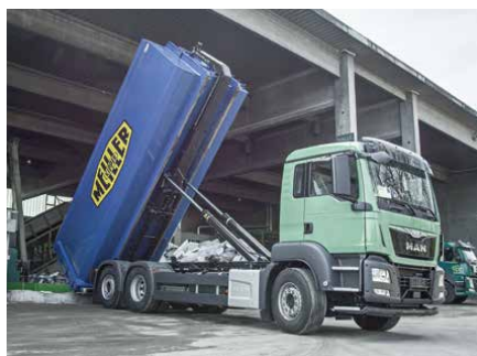
Większa przestrzeń pod zadaszzeniami dzięki niskiej zabudowie urządzenia hakowego.
