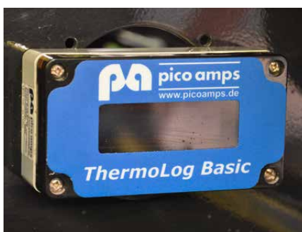
Les mesures sont effectuées toutes les minutes : un protocole de transport surveille la qualité de chaque chargement.
