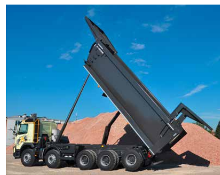
L'élévation de la porte arrière permet une plus grande ouverture de passage, p.ex. pour les décombres lourds.
