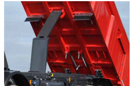
Le stabilisateur de basculement en forme de ciseaux de MEILLER garantit la sécurité du basculement.
