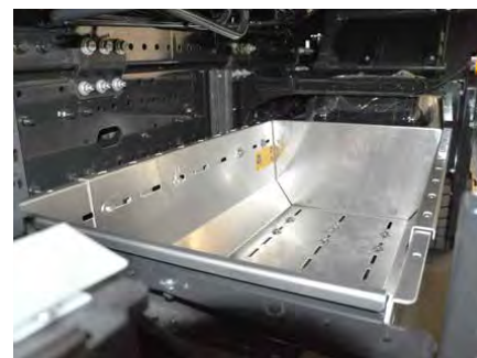
Espace optimisé : caisse ajourée à tirer entre les essieux.
