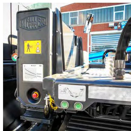
Unité de commande MEILLER avec affichage intégré du contrôle de surcharge (série pour équipement télescopique)
