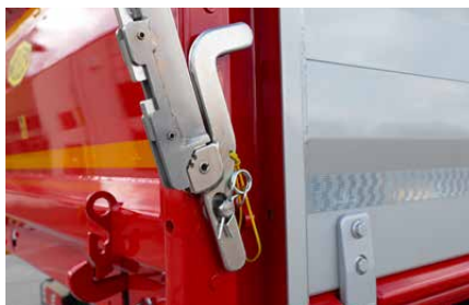
Fonctionnement conforme : avec la manivelle plate, la largeur extérieure maximale est respectée.
