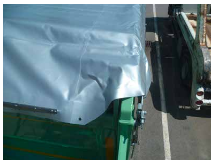
Tribenne : la bâche recouvre entièrement le palier de la porte arrière.
