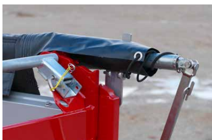
Le tube mobile rabattable évite les endommagements.
