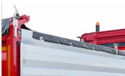
Le palier à excentrique sur la sangle supérieure de la benne permet de rendre la bâche à enroulement latéral.
