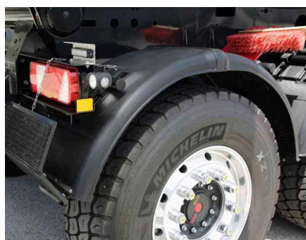
Los soportes estables para los guardabarros son imprescindibles para el uso en obras.
