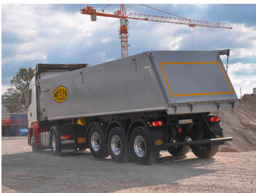
El remolque volcable MHKA cuadrado con estructura sándwich de aluminio.
