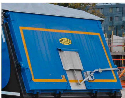
Cierre seguro y dosificación perfecta con la trampilla de cereal.
