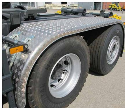
Kotflügel aus Aluminium oder Kunststoff.
