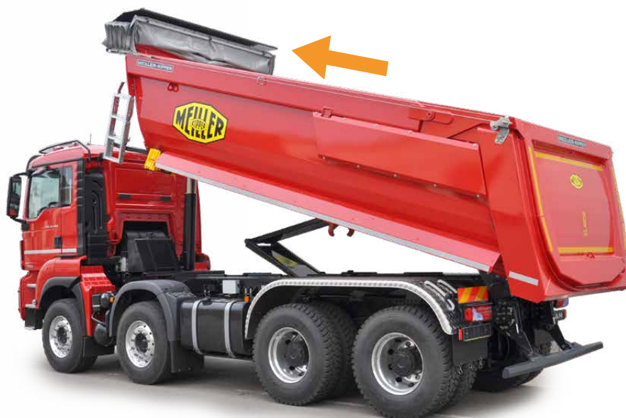
... nebo posuvná plachta, kterou lze jednoduše obsluhovat dálkovým ovládáním.
