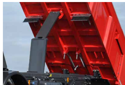
Nůžkový stabilizátor sklápění MEILLER zajišťuje bezpečnost při sklápění.
