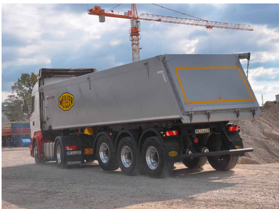
Sklápěcí návěs MHKA hliníková skříň – sendvičová konstrukce.
