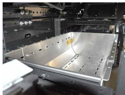
Optimální využití prostoru: Vytahovatelná přihrádka mezi nápravami.
