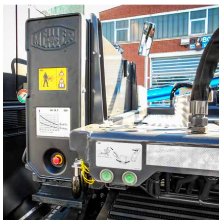
Řídicí jednotka MEILLER s integrovanou indikací kontroly přeložení (série u teleskopického zařízení)
