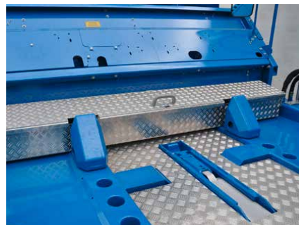
Velký úložný box s uzamykatelným víkem, umístěný příčně za předním čelem.
