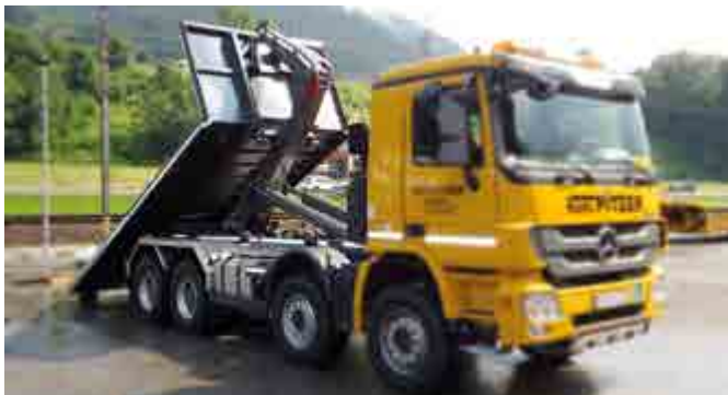
Schub-Knick-Ausleger für mehr Behältervarianz und flache Aufziehwinkel gewähren zusätzlich das Übersetzen auf Eisenbahnwaggons (ACTS).
