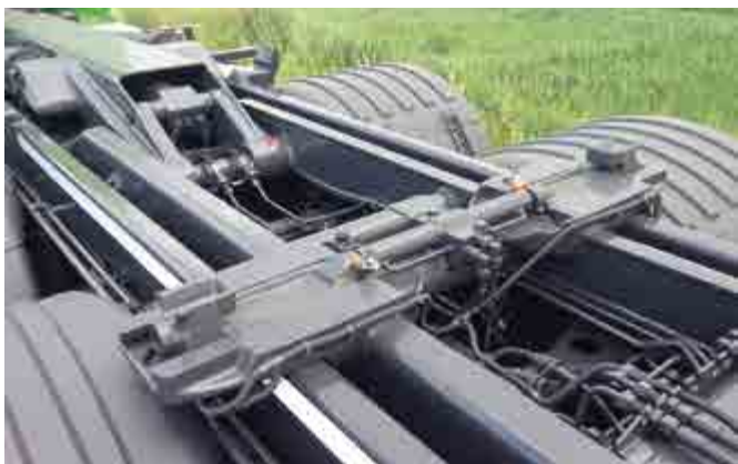
Hydraulische Behälterverriegelung für unterschiedliche Behälter
