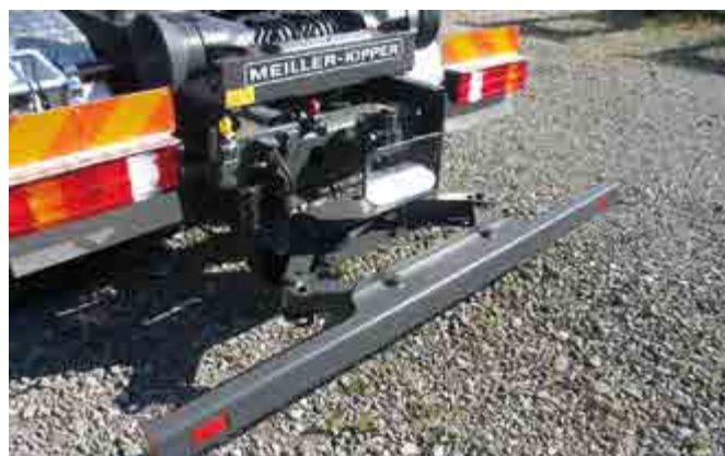
Hydraulischer Unterfahrerschutz für unterschiedliche Behälterüberhänge
