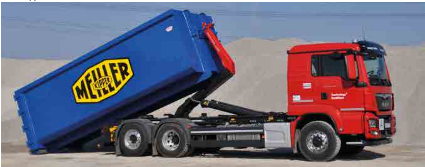
Schub-Knick-Ausleger für mehr Behältervarianz und flache Aufziehwinkel gewähren zusätzlich das Übersetzen auf Eisenbahnwaggons (ACTS).
