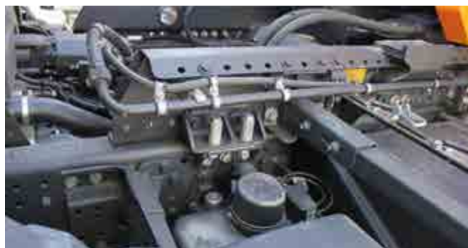
Der neue Abrollkipper-Rahmen in geschraubter Bauweise ermöglicht die Montage bei Ihrem MEILLER Servicepartner vor Ort.
